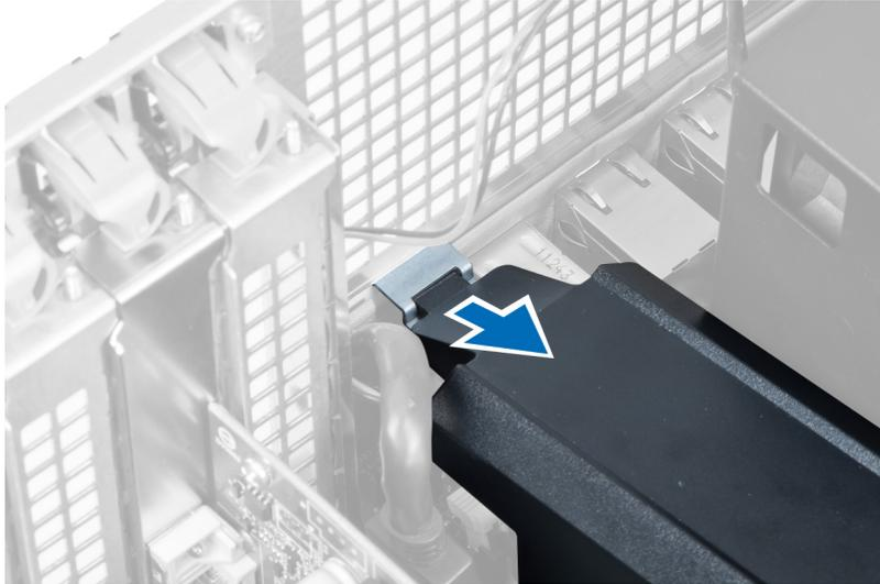
5. Appuyez sur le loquet de libération et soulevez la base du tunnel d'air pour le retirer.
