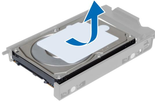
9. Si un disque dur de 2,5 pouces est installé, poussez les clips de retenue et soulevez le lecteur pour le retirer du chariot de disque dur 3,5 pouces.
